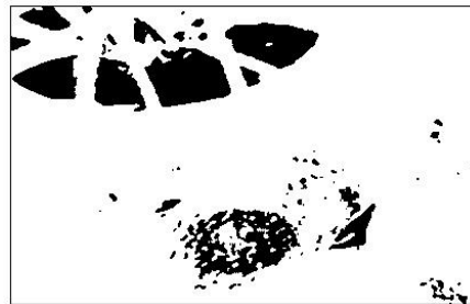
Figura 4. Resultado de aplicar el proceso de segmentación a la imagen para extraer desperfectos. Los puntos válidos se representan en negro y los puntos inválidos en blanco.
